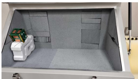
図 12 シールドボックス内での受信感度試験
