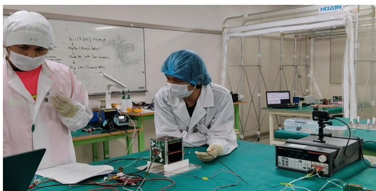
図 10 システム機能試験時の様子（衛星は試験用治具にのっている）
