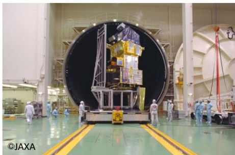
図 17 大型衛星の熱真空試験（左）と超小型衛星の熱真空試験
