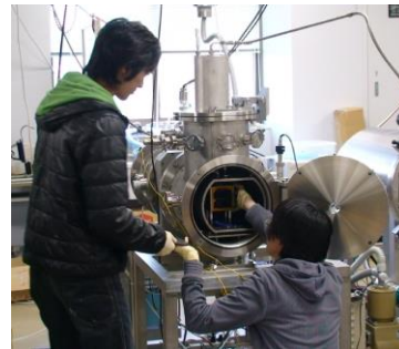
図 17 大型衛星の熱真空試験（左）と超小型衛星の熱真空試験
