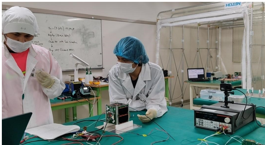
図5 システム機能試験時の様子（衛星は試験用治具にのっている）
