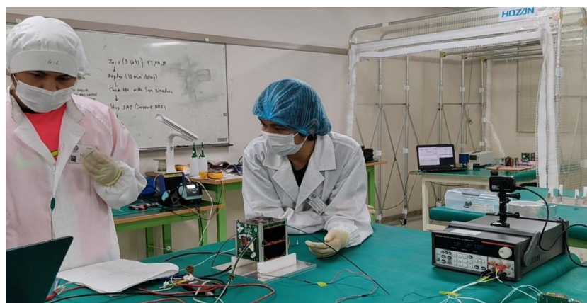
図5 システム機能試験時の様子（衛星は試験用治具にのっている）
