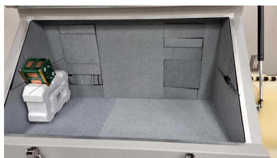
図 6 シールドボックス内での受信感度試験
